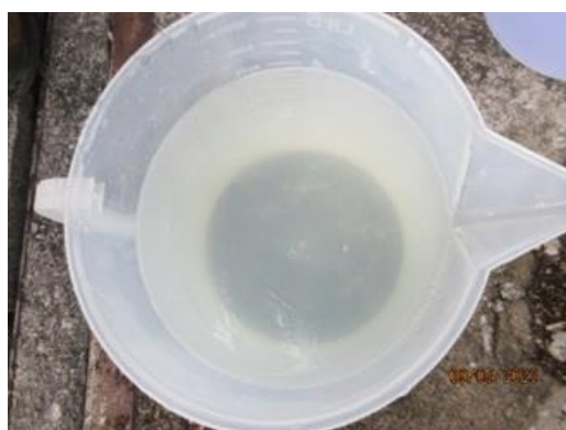
บริเวณ Inspection Pit หลังผ่าน API Separator ของโรงงาน HDPE4
